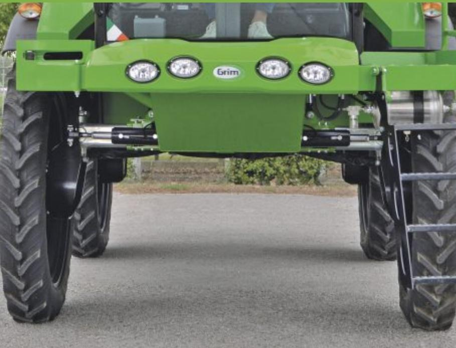
Regolazione rapida della carreggiata per adattarsi ad ogni tipo di interfila.
