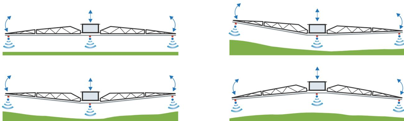
**IT** Per un lavoro di irrorazione uniforme la stabilità della barra è molto importante. Per questo motivo tutte le nostre barre sono equipaggiate con sospensione ad aria sul telaio di sollevamento a parallelogramma, sistema di bilanciamento a pendolo e geometrie variabili indipendenti con accumulatori di azoto. Come accessorio opzionale, sono disponibili 2 sistemi di regolazione automatica dell'altezza barra: a 2 sensori o 3 sensori.
